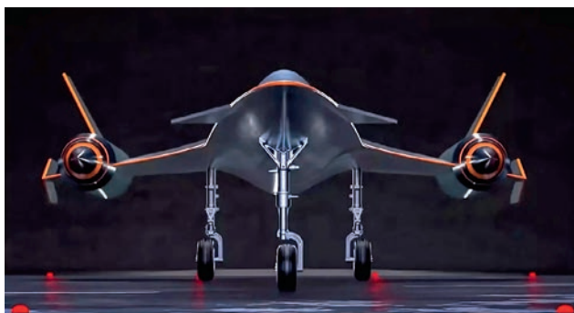
Изображение проектируемого сверхзвукового пассажирского самолёта Yunchang китайской компании Space Transportation с крейсерской скоростью 4900 км/ч, или 1360 м/с
